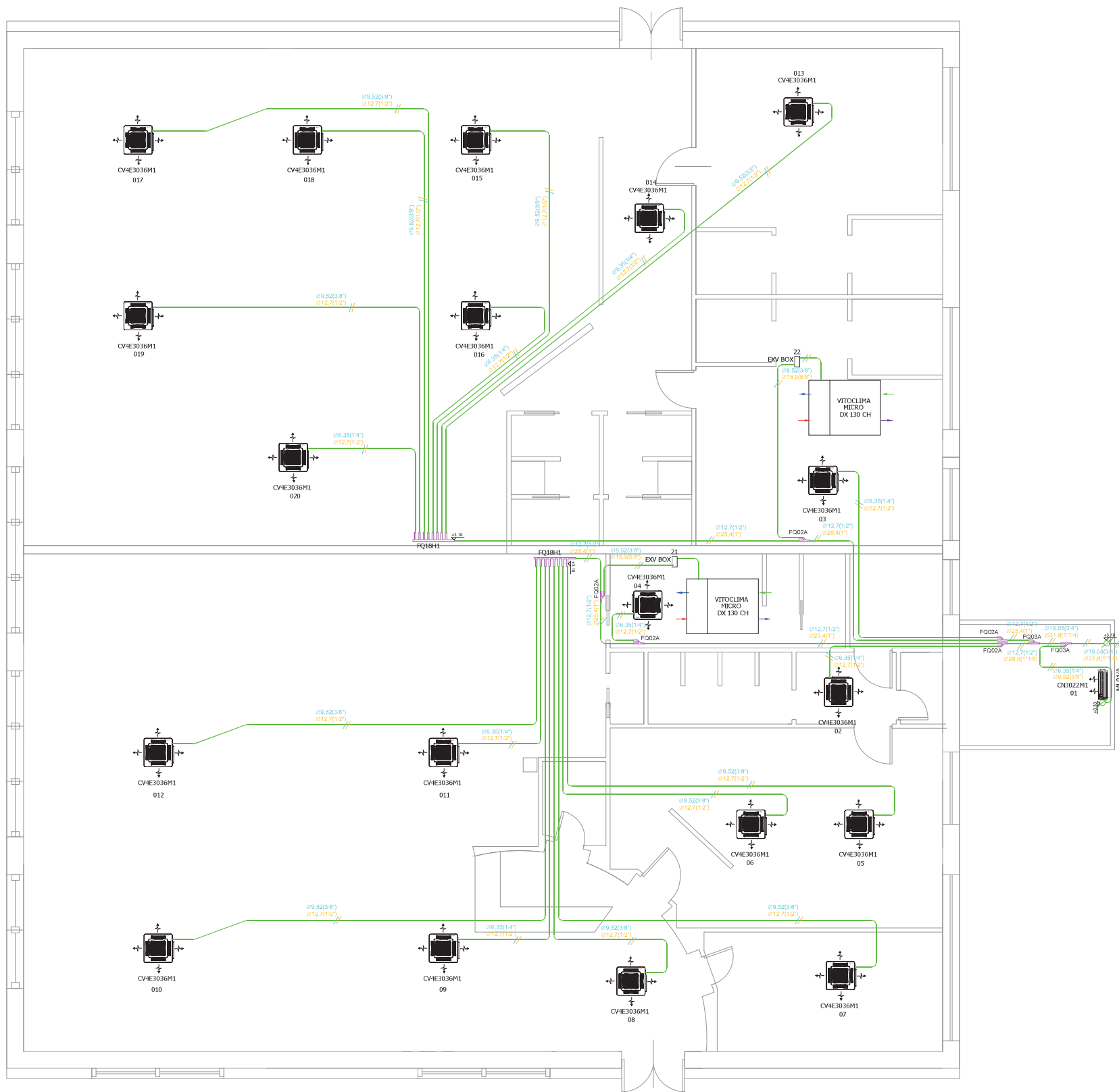
Schema funzionale dell'impianto VRF
